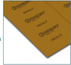
MICALIT® F es un material a base de mica. Tiene una excelente resistencia térmica y química adecuados a las condiciones de alta temperatura de la industria automotriz y siderúrgica, sistemas de escape, quemadores y hornos. Tiene buen aislamiento eléctrico y baja conductividad térmica.
